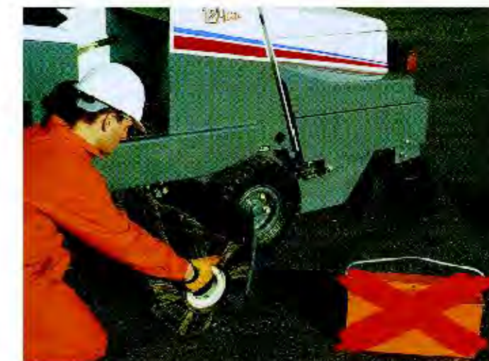
Smontaggio della spazzola centrale senza l'utilizzo di attrezzi
